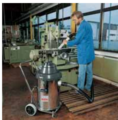
MULTISOG-3 an einem Bohrwerk
