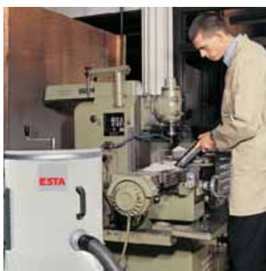
Mit der Schrägrohrdüse werden auch die „hintersten“ Winkel sauber
