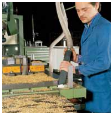
Entsorgung von abgelagerten Messingspänen und Kühlmitteln
