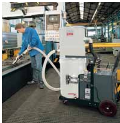
Absaugung von Spänen und Emulsionen an einem CNC-Fräszentrum
