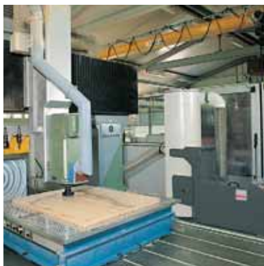
DUSTOVAC an einer CNC-Bearbeitungs- maschine
