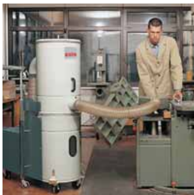
DUSTOMAT-10 an einer Holzbearbeitungs- maschine
