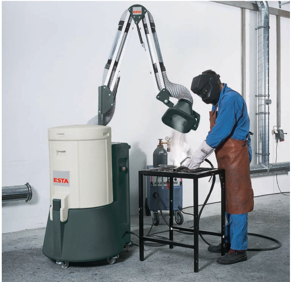
SRF K-10 beim Einsatz an einem Schweißplatz
