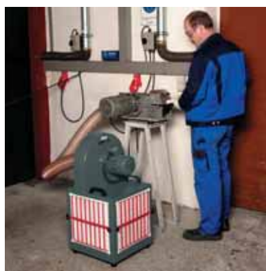
ESTA 100 an einer Bandschleifmaschine
