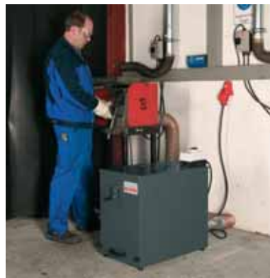
Kleinentstauber TK an einer Entgratmaschine
