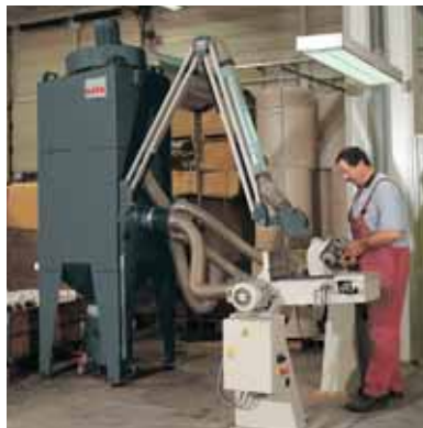
Nassabscheider NA-K beim Absaugen von Aluminiumstäuben
