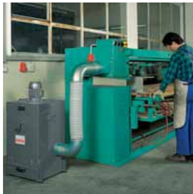
Kleinststauber OM an einer Oberflächen-Bearbeitungsmaschine
