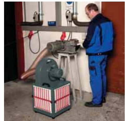
ESTA 100 an einer Bandschleifmaschine
