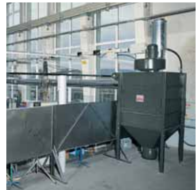
Modularer Entstauber DUSTEX in der Metallverarbeitung
